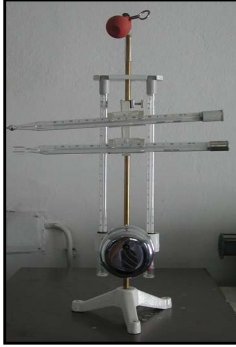
Şekil 5.15. Psikrometre takımı ve ekstrem termometreler
