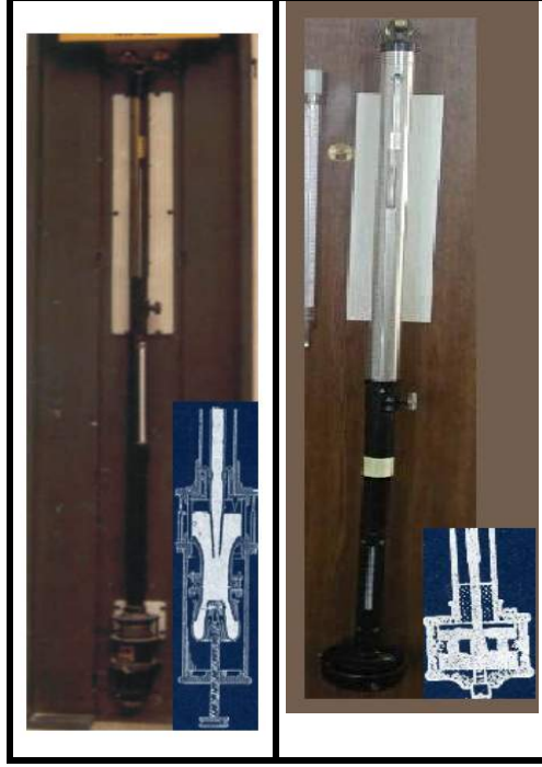
Şekil 4.2. Değişken hazneli barometreler. Şekil 4.3. Sabit hazneli barometreler.
