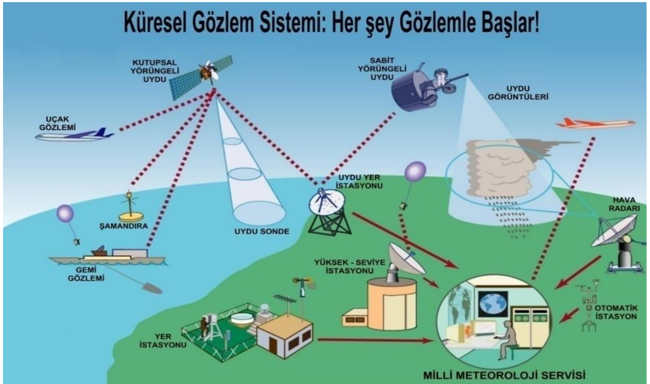
Şekil 3: Küresel Gözlem Sistemi
