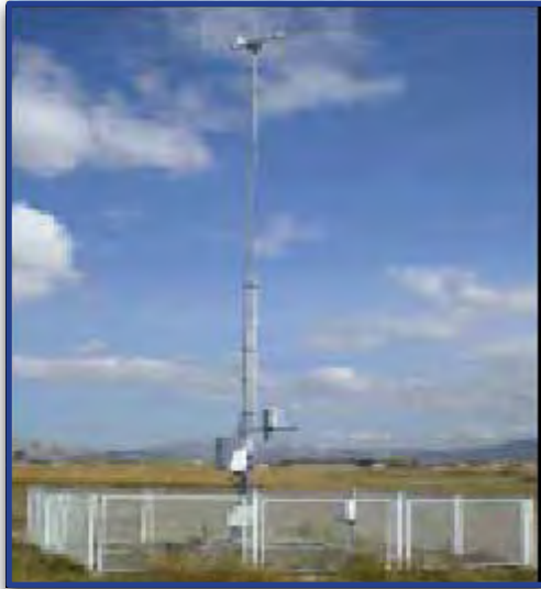
Resim -2 Otomatik Meteoroloji Gözlem İstasyonu
