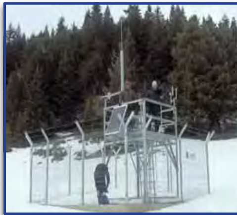
Resim-3 Otomatik Kar Ölçüm İstasyonu
