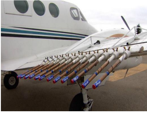
Şekil 6. Uçak kanadına takılmış bulut tohumlama fişekleri ve 50 gr gümüş iyodür içeren bulut tohumlama fişekleri
