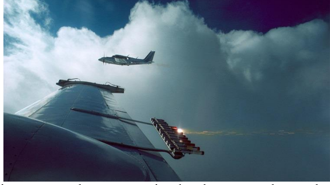
Şekil 5. Yağmur damla çapını ölçen sistem ve uçaktan gümüş iyodür dumanı püskürterek gerçekleştirilen bir bulut tohumlama işlemi
