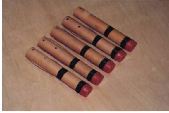
Şekil 6. Uçak kanadına takılmış bulut tohumlama fişekleri ve 50 gr gümüş iyodür içeren bulut tohumlama fişekleri
