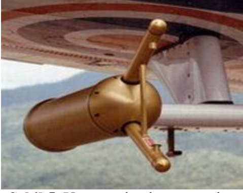
Şekil 5. Yağmur damla çapını ölçen sistem ve uçaktan gümüş iyodür dumanı püskürterek gerçekleştirilen bir bulut tohumlama işlemi
