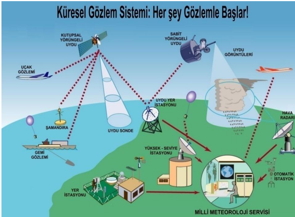
Şekil 3: Küresel Gözlem Sistemi
