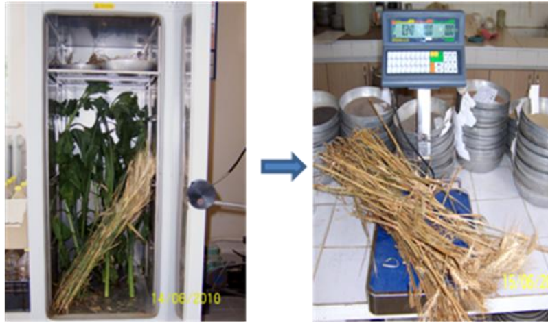
Şekil 6: Bitkiden alınan örnek etüvde kurutularak biyokütle ölçümü yapılmaktadır.
