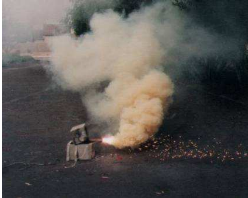
Fotoğraf-8 Bir bulut tohumlama cihazının deneme atış
