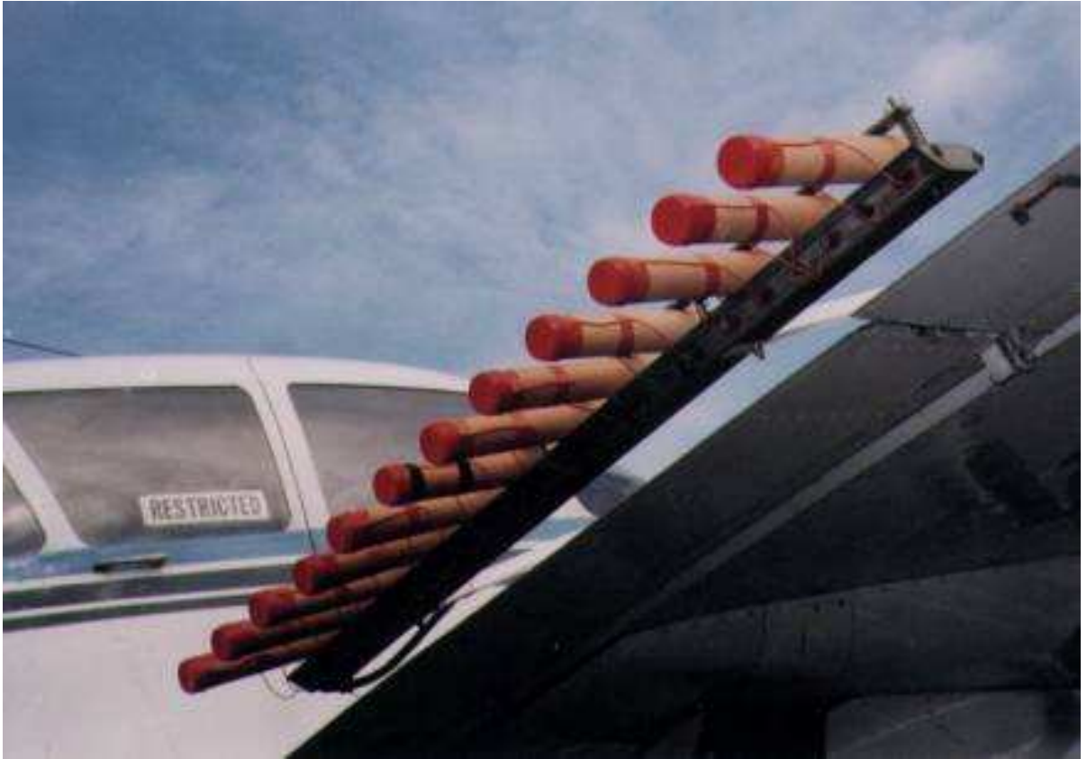
Fotoğraf-6 Uçak kanadına takılmış bulut tohumlama fişekleri
