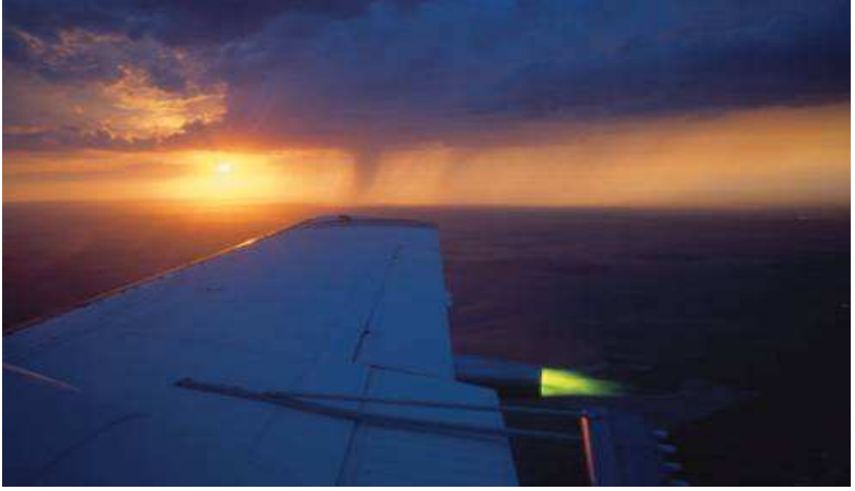
Fotoğraf-5 Resimde uçaktan gümüş iyodür dumanı püskürterek gerçekleştirilen bir bulut tohumlama işlemi görülmektedir
