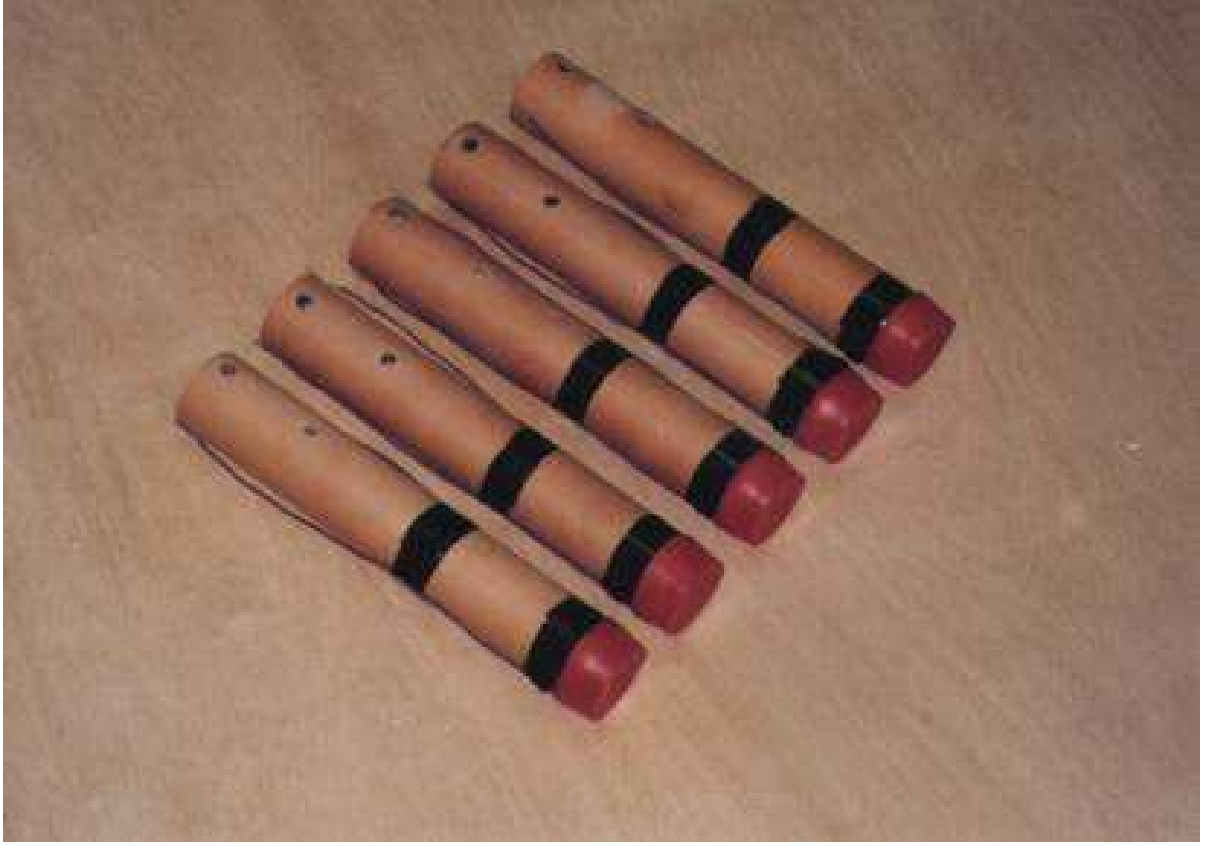
Fotoğraf-7 50 gr gümüş iyodür içeren bulut tohumlama fişekleri
