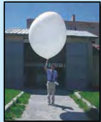
Resim 6- Ravinsonde balonu ve cihazı
